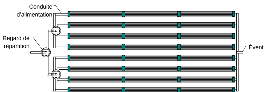
Figure 12 – Alimentation par des regards de répartition en série
